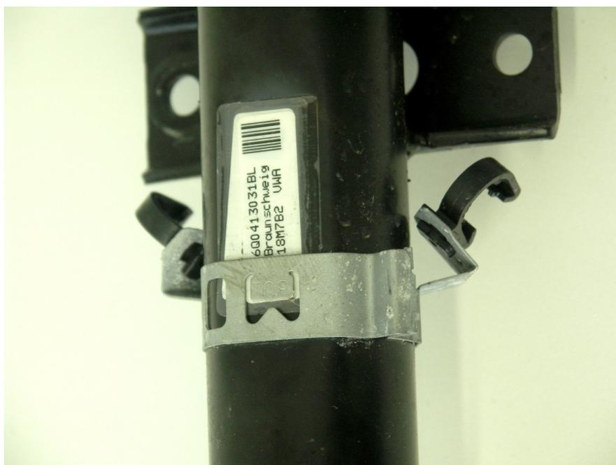
**Abb. 2/ Fig.2:** Original-Bremsschlauchhalter/OE brake hose bracket
